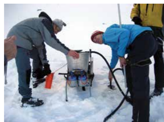
Foto oben: Erstmalsiges Bohren eines Eispegels mit dem Dampfbohrer (2008)
