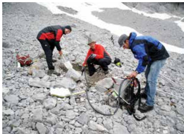
Foto unten: Der Eispegel A wird neu gebohrt. V.l.: Peter Lederer, Erwin Hohenwarter, Marcus Scherer (29.6.2015)
